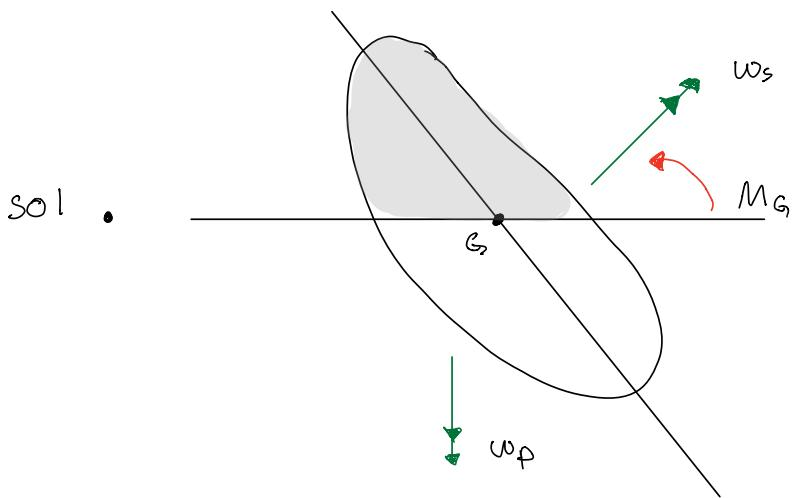
Påverkningas en spinnande rotor en precession, skapas ett moment
