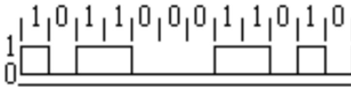
Figur C.2: Ett exempel på unipolär modulation. Bild tagen från en.wikipedia, skapad av användare Mancini.
